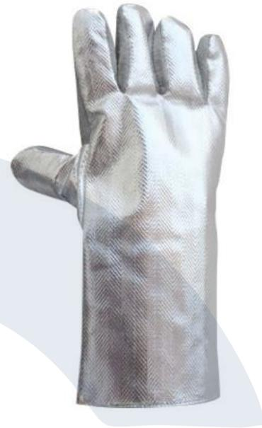
Guantes para actividades con exposición a altas temperaturas, fabricados de tela viscosa (rayón) aluminizada DICKSON. La lámina de aluminio cumple la función de reflejar el calor radiante y la viscosa (rayón) cumple la función de aislante térmico.
